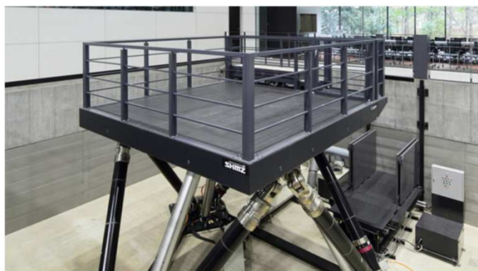
長周期・3次元の揺れを再現できる実験設備「E-Spider」
