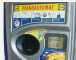
●ドイツのデポジット制ペットボトル圧縮機
