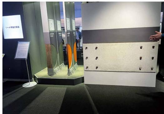
▲左から原子炉圧力容器、原子炉格納容器、原子炉建屋のコンクリート壁の厚さ比較の展示
